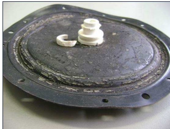
FIGURA 46 – DEGRADAÇÃO DAS CÁPSULAS PLÁSTICAS (ESBRANQUIÇADAS). DETERIORAÇÃO DO DIAFRAGMA DO REGULADOR DE PRESSÃO.
