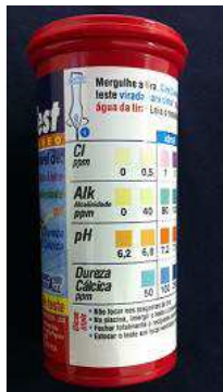
FIGURA 43 – ESCALA DE COR EM FITA REAGENTE PARA DOSAGEM RÁPIDA DE CLORO ATIVO.
