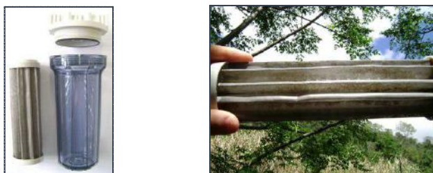
FIGURA 41 – FILTRO DE ÁGUA (NOVO) E ELEMENTO FILTRANTE SUJO.
