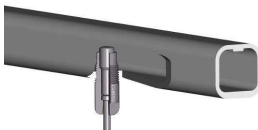
FIGURA 1 – DESENHO EM CORTE DE UM NIPPLE ROSQUEADO NO TUBO PVC
