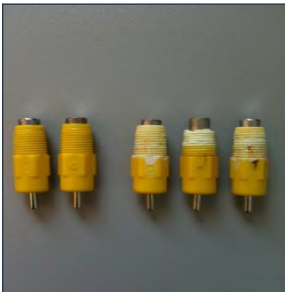
FIGURA 46 – DEGRADAÇÃO DAS CÁPSULAS PLÁSTICAS (ESBRANQUIÇADAS). DETERIORAÇÃO DO DIAFRAGMA DO REGULADOR DE PRESSÃO.
