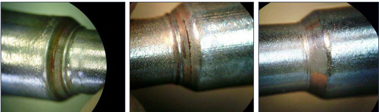
FIGURA 51 – FOTO DE MICROSCOPIA DO PINO SUPERIOR DE NIPPLE COM INCRUSTAÇÃO (ESQUERDA E CENTRO). APÓS LIMPEZA (DIREITA).
